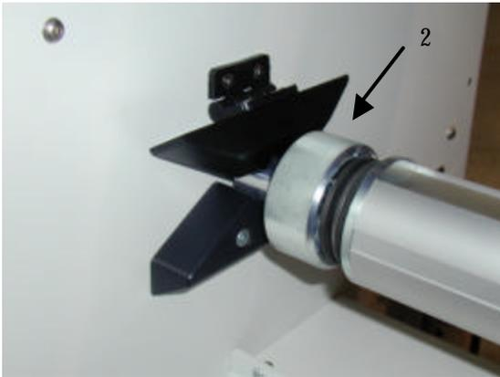
**Figure 15: Unwind Brake**
